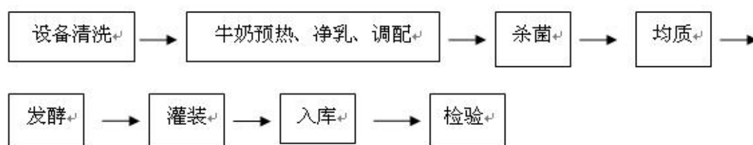
图 1-1 生产工艺流程图
